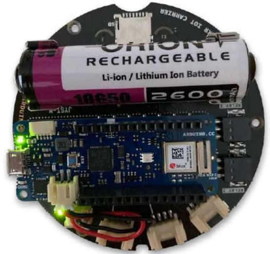
Bild 3. Der Batteriehalter macht das Oplà IoT-Kit mobil.
