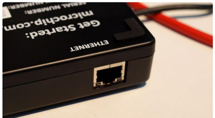
Bild 1. Dieser Port ermöglicht das Anschließen per Power over Ethernet.
