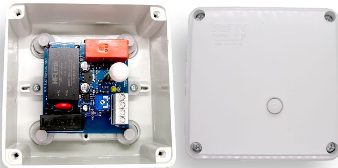
Bild 4. Der gebrauchsfertige PIR-Schalter in seinem endgültigen Zuhause.
