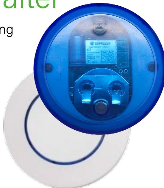
Bild 1. Der ESP32-C2-basierte Knopfzellenschalter in seinem Gehäuse.
