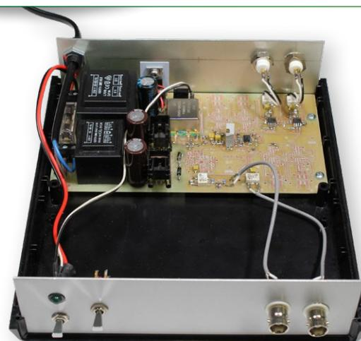
Bild 4. Eine teilbestückte Platine eingebaut in ein Teko-Gehäuse.
