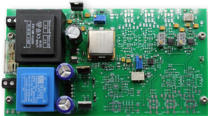
Bild 3. Die teilbestückte Platine des Prototypen.
