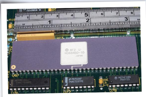
Bild 1. DMA-IC HD68450 für Motorolas Mikrocomputer der Serie 68000, in einem Keramikgehäuse.
