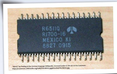
Bild 3: Quad-In-Line-IC RS6511. (Quelle: Guido Körber / Wikimedia Commons, CC BY-SA 3.0)
