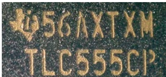
▶ Abbildung 5: Das Logo auf diesem TL082 sieht einem echten Texas Instruments-Logo auf einem 555er sehr ähnlich, ist aber nicht identisch damit.
