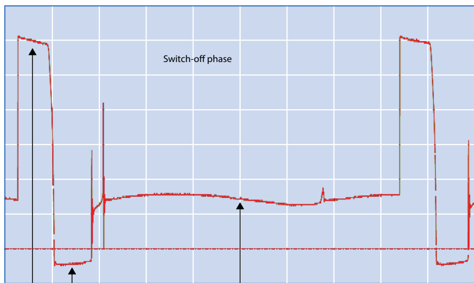
Figuur 7: De snelheid wordt gemeten in de uitschakelfase na demagnetisatie.
