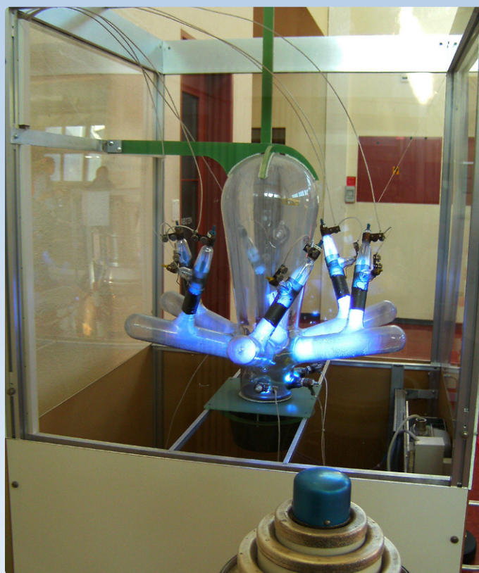
Figuur 1: Een 6-fasige, hoogvermogen kwikdampgelijkrichter in werking. (Bron: Wikimedia Commons, https://commons.wikimedia.org/wiki/File:Quecksilberdampfgleichrichter_in_Betrieb.JPG )
