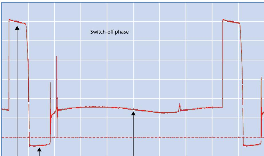
Figure 7. La vitesse est mesurée dans la phase d'arrêt après la démagnétisation.
