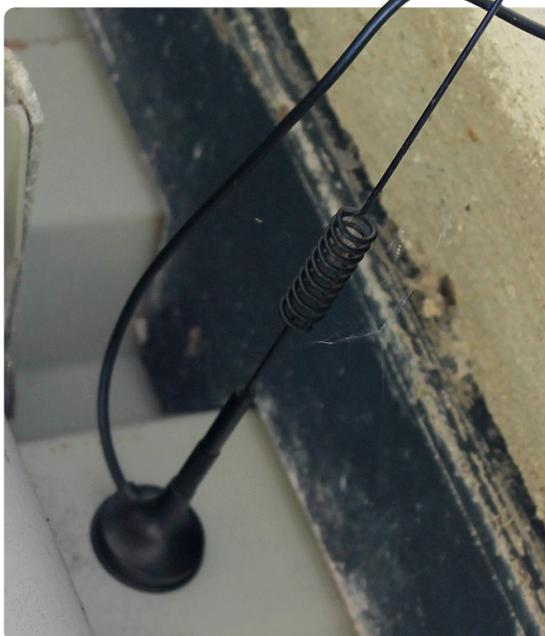
◀ Bild 4. Die Empfängerantenne sitzt auf dem Metalldach des Schuppens.
