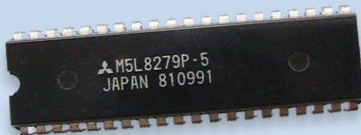
Bild 1. Ein Second-Source-IC 8279 von Mitsubishi. (Bild von JWBE - Eigenes Werk, CC BY-SA 3.0, <https://commons.wikimedia.org/w/index.php?curid=20019181>)
