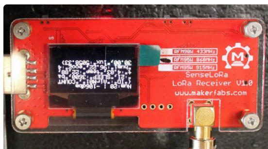
Bild 1. Der Empfänger verfügt über ein kleines Display, das die empfangenen Daten im JSON-Format anzeigt.
