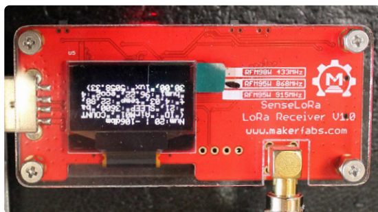
Figuur 1: De ontvanger heeft een klein scherm dat ontvangen gegevens in JSON-formaat toont.
