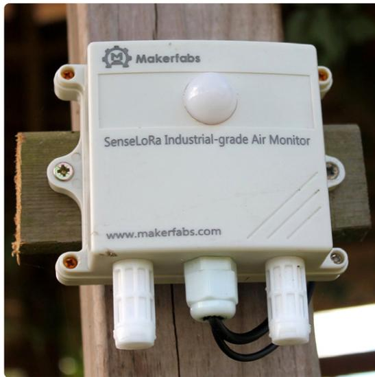
Figure 2. Le Air Monitor de qualité industrielle SenseLoRa est monté à l'extérieur, sur une structure en bois, à une hauteur de près de deux mètres.
