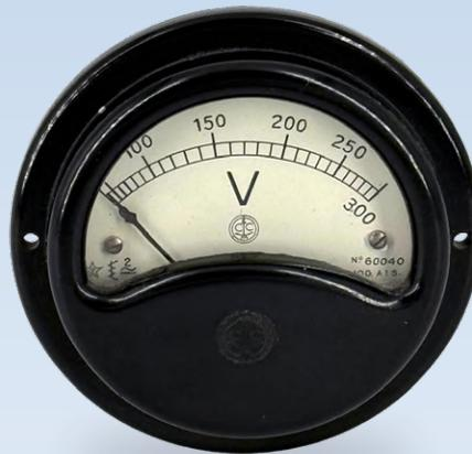
*Bild 4. Altes 300-V-Wechselspannungsmeter aus den 1940er Jahren im runden Bakelit-Gehäuse. (Quelle: Roberto Armani)*
