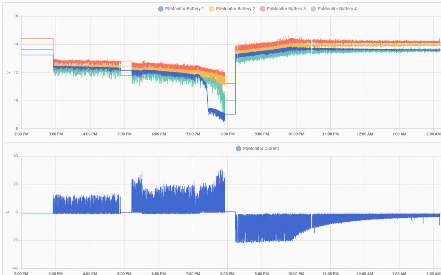
Bild 7. Lade- und Entladevorgänge der Batteriebank, angezeigt im Home Assistant History Dashboard.
