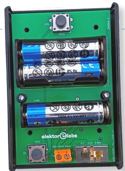
Bild 2. Die Schaltung wird von drei 1,5-V-AA-Batterien versorgt.
