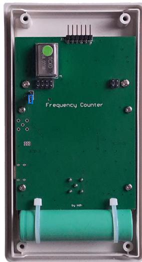
Bild 6. Die bestückte Vorderseite der Platine ohne Display und Abschirmung (links), fertiggestellt (Mitte) und die Rückseite der Platine, montiert im oberen Teil des Gehäuses (rechts).
