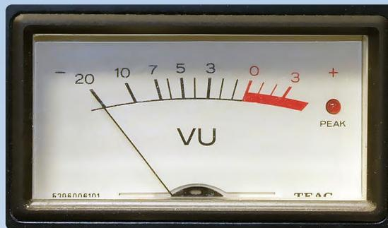
*Bild 3. VU-Meter, kalibriert in Dezibel, dieses hat auch eine Spitzenwert-LED. (Quelle: Wikipedia - Iainf - Creative Commons License, [https://it.wikipedia.org/wiki/VU\\_meter#/media/File:VU\\_Meter.jpg](https://it.wikipedia.org/wiki/VU_meter#/media/File:VU_Meter.jpg))*
