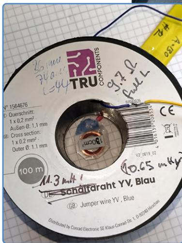
Bild 12. Versuch der Kalibrierung mit der Drahtspule als „Kalibrierungsspule“ bei einem Strom von 2 A (nur für einige Sekunden!). Rechts: Die Sondenspule ist in der Mitte des Spulenendes positioniert.
