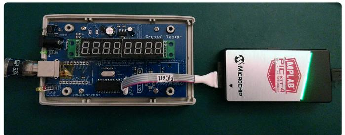
Bild 6. Programmierung des PICs über den ICSP-Verbinder durch ein PICkit 4 von Microchip.
