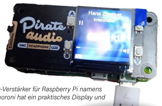
Bild 2. Der Kopfhörer-Verstärker für Raspberry Pi namens *Pirate Audio* von Pimoroni hat ein praktisches Display und vier GPIO-Tasten.
