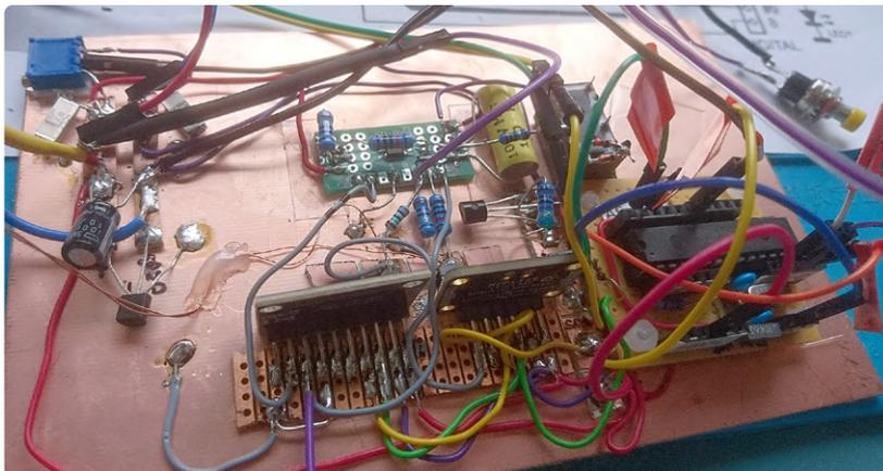
▲ *Bild 2. Die Schaltung auf einer kupferkaschierten Platine vor dem Einbau in das Gehäuse. Der gelbe Kondensator (oben Mitte) wurde später gegen einen anderen Typ ausgetauscht.*
