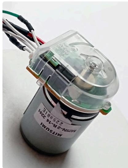
Bild 10. Gleichstrommotor mit Encoder-Rad.
