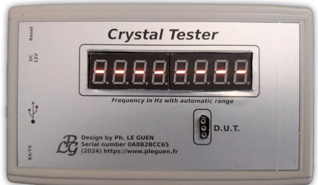
Bild 7. Striche auf dem Display können darauf hinweisen, dass der zu prüfende Quarz fehlt, defekt ist oder mit einer für die Messung zu niedrigen Frequenz schwingt.
