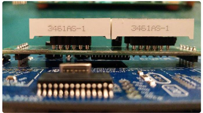
Bild 5. Die Anzeigeplatine wird auf die Hauptplatine des Quarztesters gesteckt.
