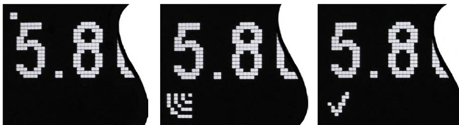
Bild 8. Kleine, aber wichtige Symbole: der aktualisierte Anzeigewert (links), der empfangene GPS-Ausgangsimpuls (Mitte) und zehn aufeinanderfolgende erfolgreiche GPS-Impulse (rechts).
