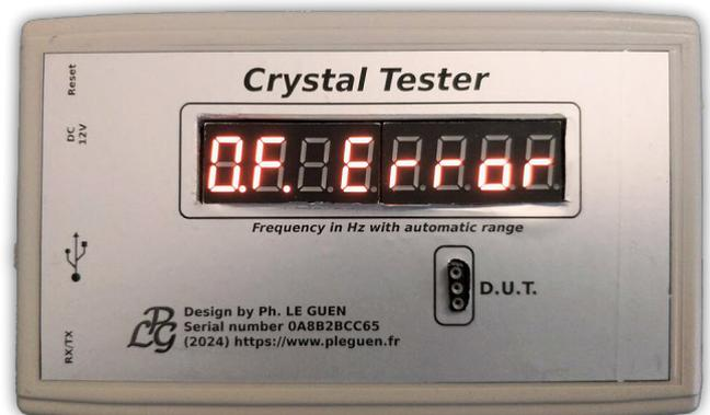
Bild 8. Wenn die Anzeige „0.F. Error“ (Überlauferfehler) anzeigt, ist die Frequenz des Quarzes für eine korrekte Messung zu hoch.
