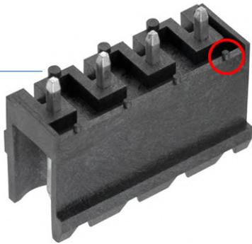
Bild 1. Abstandshalter eines THR-kompatiblen Terminal Block sorgen dafür, dass das Bauteil nicht mit der Lotpaste in Berührung kommt.
