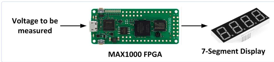
Bild 5. Blockschaltbild des FPGA-Voltmeters.
