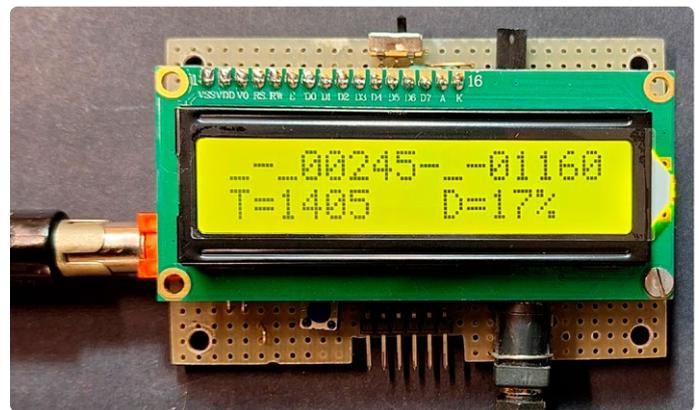
Bild 6. Anzeige der High-Pulsdauer (245 µs), des Low-Pulses (1.160 µs), der Gesamtperiode T (1.405 µs) und des Tastverhältnisses (17 %).
