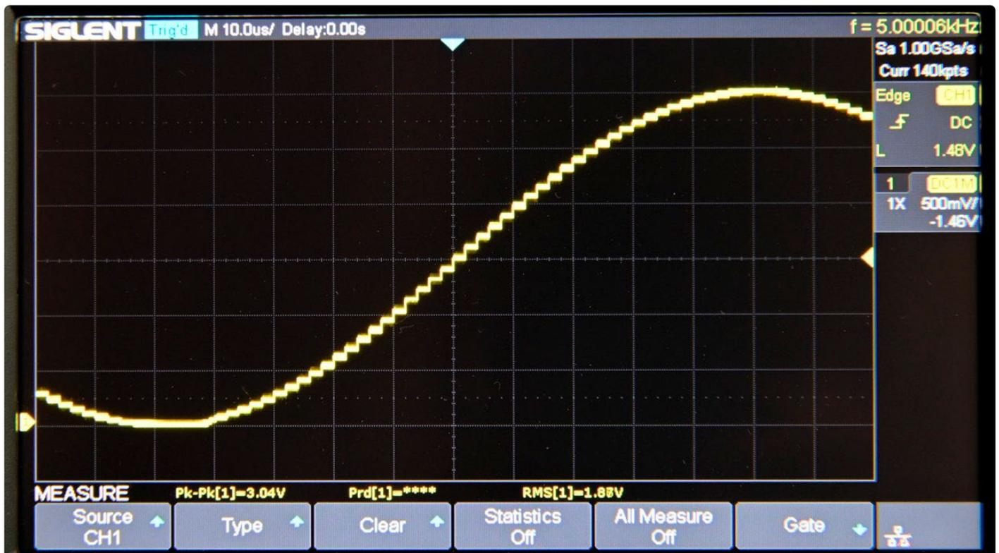
Bild 5. Die Signale des Funktionsgenerators sind recht grob und man kann die Quantisierungsschritte deutlich erkennen.
