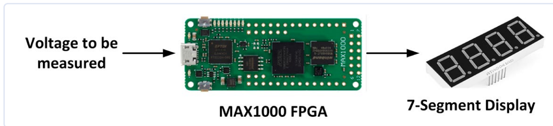
Figuur 5. Blokschema van het voltmeter-project.
