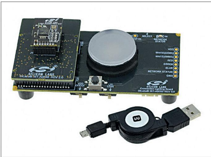
Illustration 4. Le module de référence de nœud d'éclairage communicant RD-0085-0401 proposé par Silicon Labs associe un module radio basé sur le SoC EFR32-Mighty-Gecko, programmable par l'utilisateur, et une LED sophistiquée.
