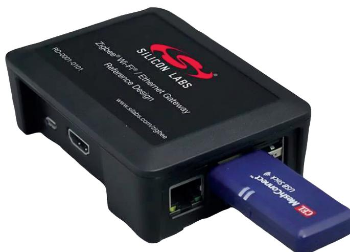
Illustration 3. La passerelle zigbee (réf. Silicon Labs RD-0001-0201) est basée sur un Raspberry Pi.
